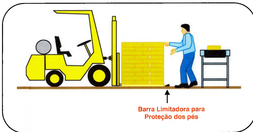
Figura 12 – posição da barra limitadora de proteção para os pés.
